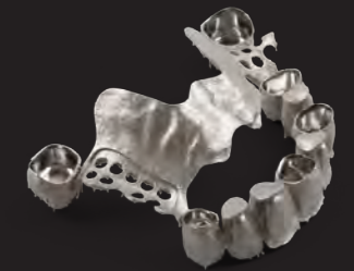
Fräsergebnisse mit hoher Oberflächengüte
