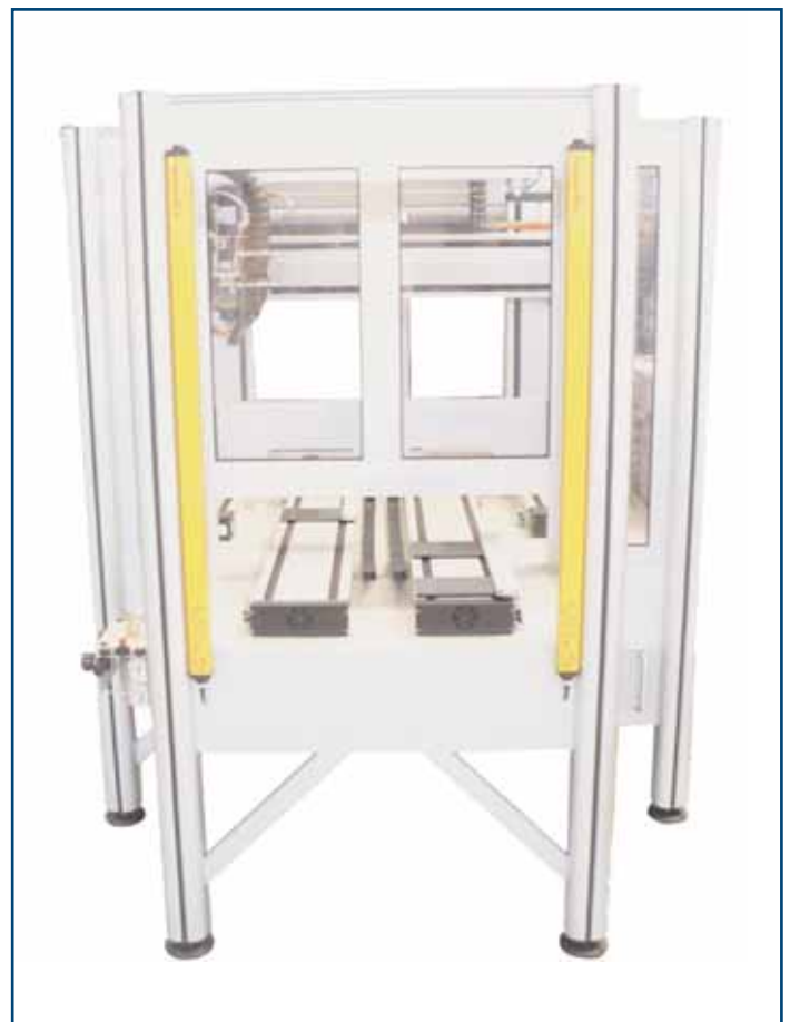
CNC-Systeme mit integriertem Wechseltisch und Überwachung mittels Lichtschanke / CNC systems with integrated loading table und safety light barrier
