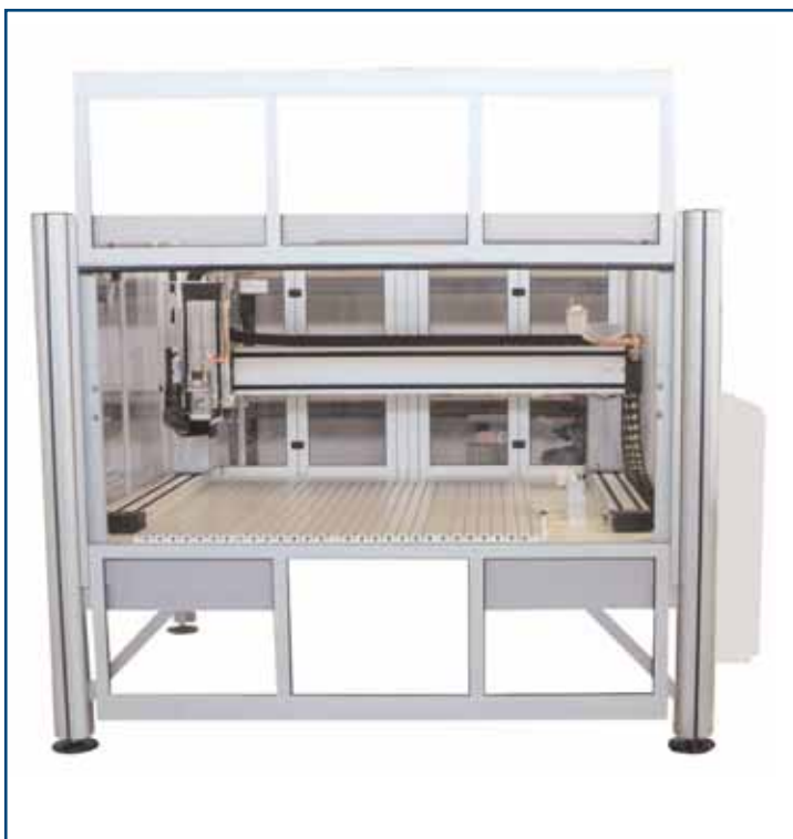
Pneumatisch betätigte Schutztür gekoppelt mit dem NC-Programm/ pneumatic front safety door coupled with NC program
