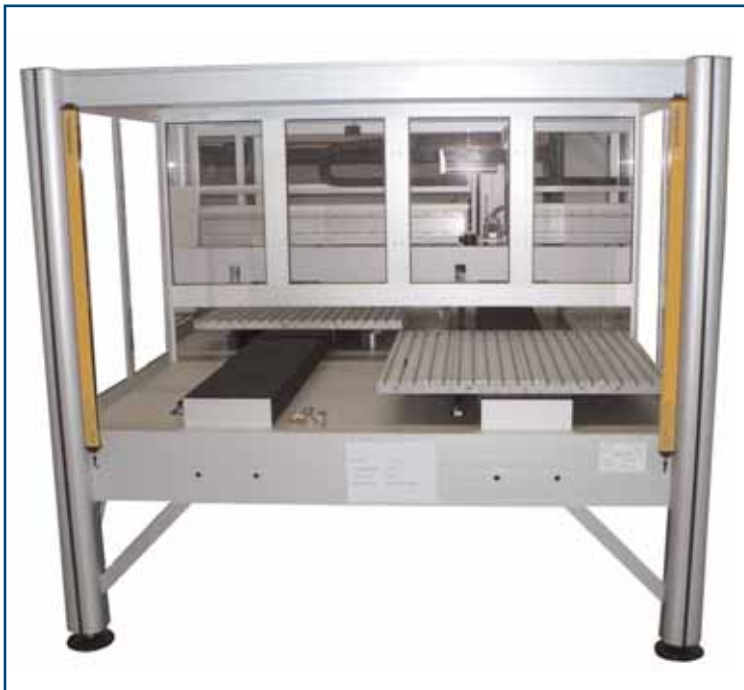
CNC-Systeme mit integriertem Wechseltisch und Überwachung mittels Lichtschanke / CNC systems with integrated loading table und safety light barrier
