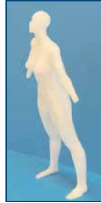
3D-Figur gefräst mit "Gieß-Spannverfahren" / 3D figure milled with mould clamping system
